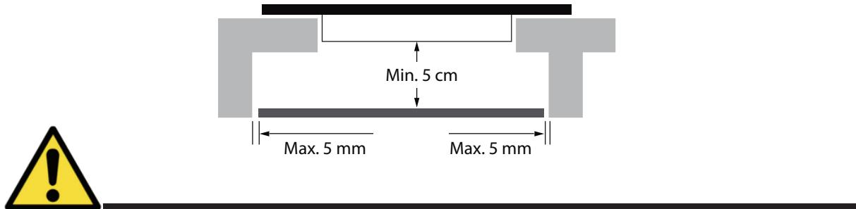
Снаружи варочной панели имеются вентиляционные отверстия. Вы ДОЛЖНЫ убедиться, что эти отверстия не заблокированы столешницей, когда Вы устанавливаете варочную панель на место.
