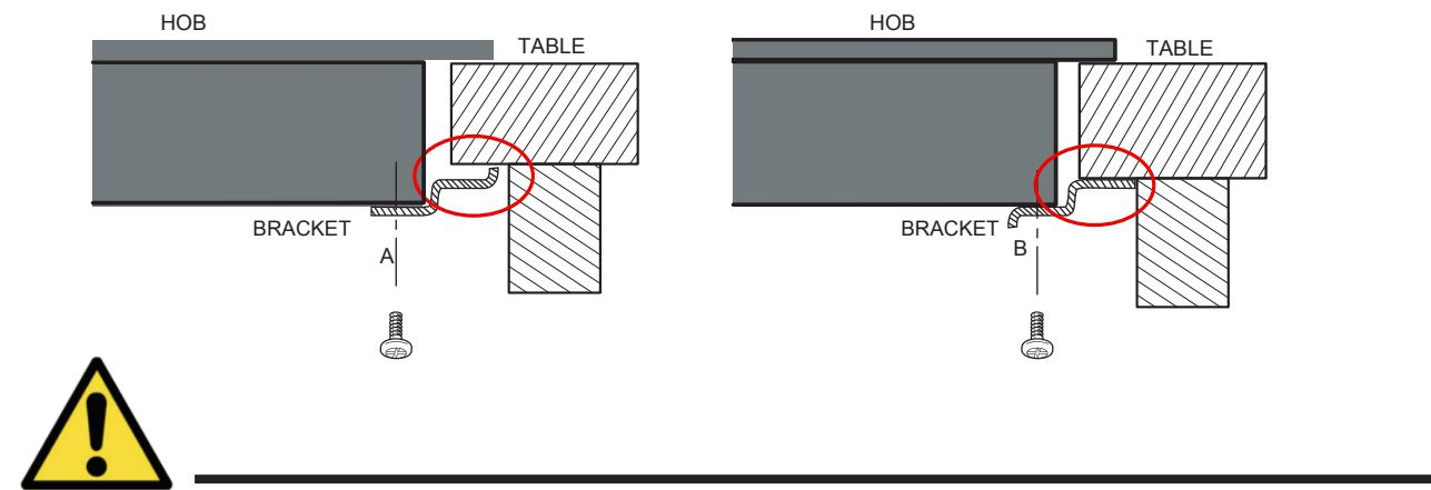
При любых обстоятельствах, скоба не должна соприкасаться с внутренней поверхностью столешницы после установки (см. рисунок).
